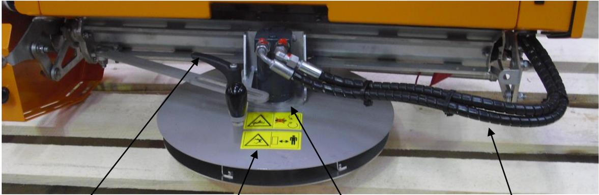
Verriegelungshebel      Aufkleber      Hydraulikmotor      2 Hydraulikschläuche
